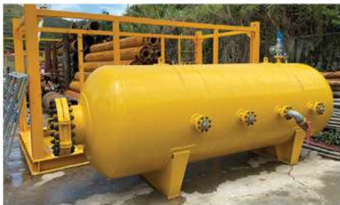
風罐、風機吊運架及油兜
