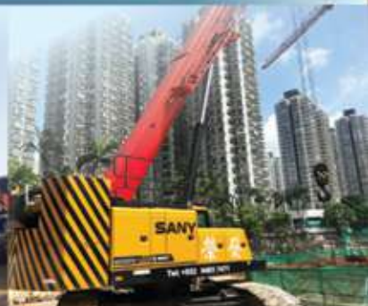
SANY SCC550TB 履帶式伸縮吊臂：42m
