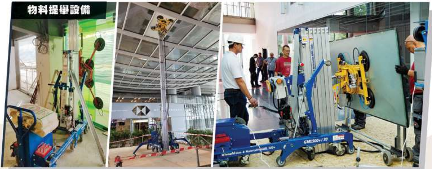
蜘蛛起重機及電吸盤
