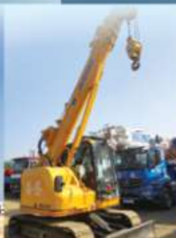
MAEDA LC785M-8B 吊機噸位：4.9噸
